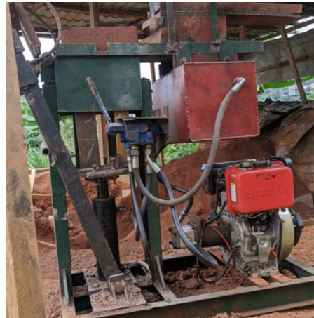
Réalisation de la presse semi-automatique projetée pour la production des pates semi-sèches de matrices écologiques, Simbock-Yaoundé, Cameroun
