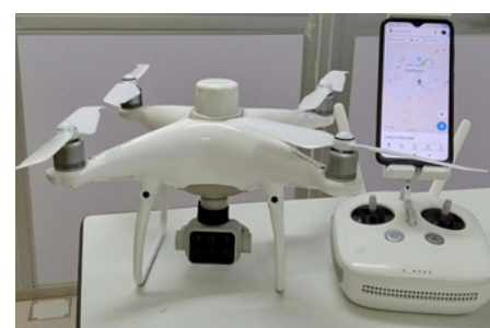
Le drone multispectral Phantom 4 optimisé pour la cartographie numérique en agriculture au Burkina Faso (WASCAL, 2021)
